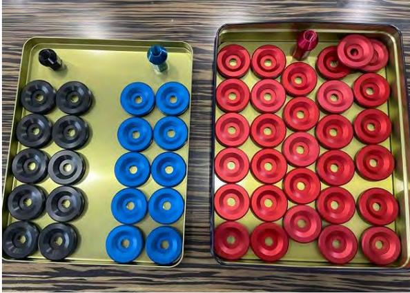
ゴム部品の機械加工(試作最適)
